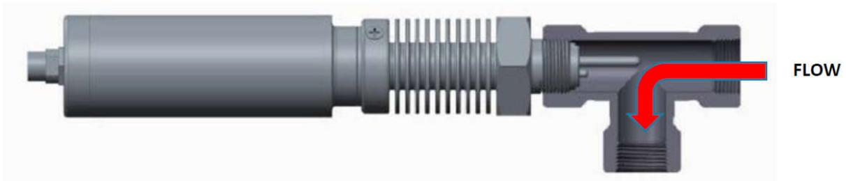
图 4. CR-301传感器安装在流路中
