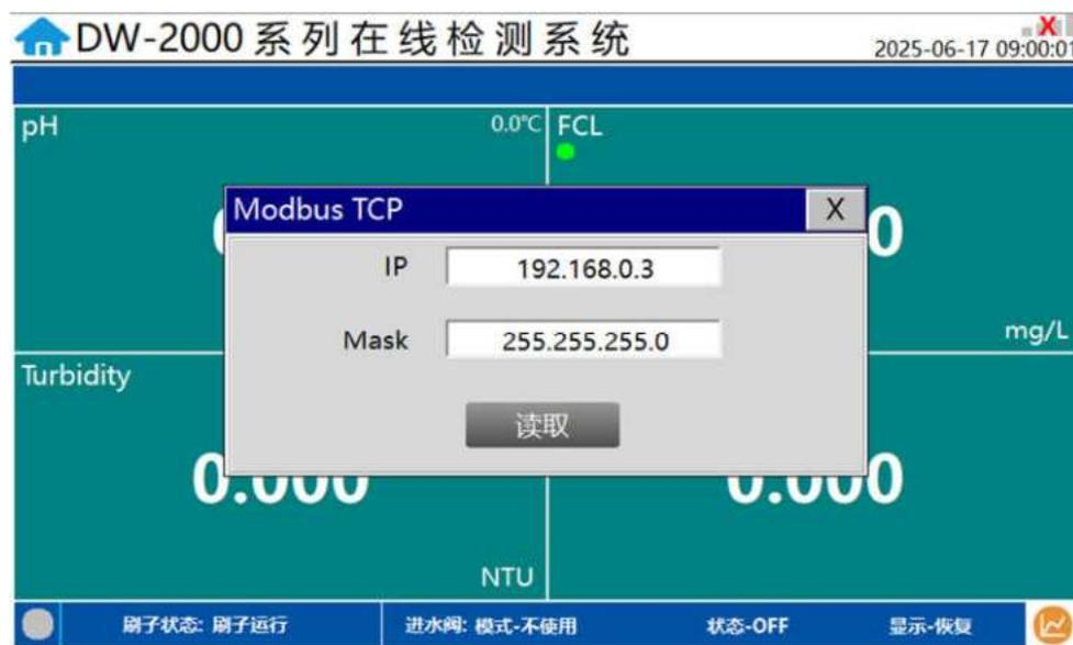
图 22 Modbus TCP 参数设置
