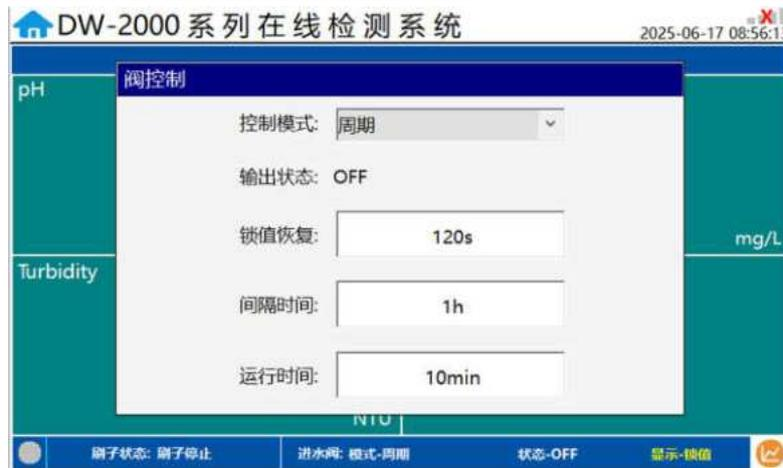
图 13 阀控制参数界面
