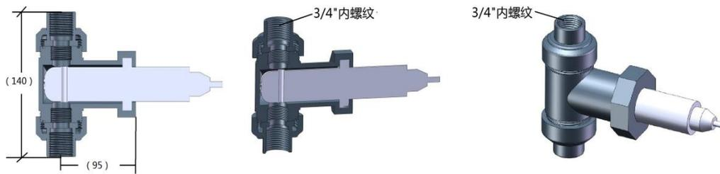
探头安装三通 (3/4" ) 螺纹口
