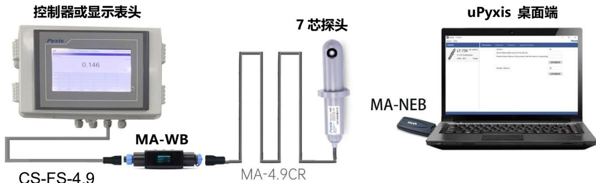
图 4-7 MA 系列蓝牙适配器连接
