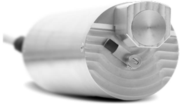
Pyxis 公司全新开发的 LT-635 在线式污泥浓度仪，采用双光束红外和吸收光检测浊度/悬浮物/MLSS 浓度，近红外光消除颜色干扰，双波长浊度检测技术和平端易清洗设计，大幅度提高了检测的精度、稳定性与复杂环境下的耐用性，可提供  $<0.1\text{g/L}$  测量精度的稳定性。同时标配自清洗刮片，定时自清洗光学检测面，更适合高浊度污水工况，运维更简便。
