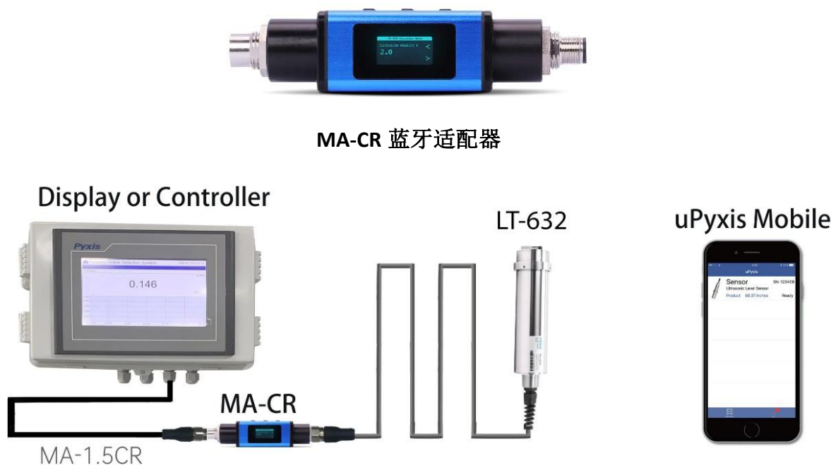
图6. 通过MA-CR和uPyxis®移动应用程序与LT-63X传感器建立蓝牙连接
