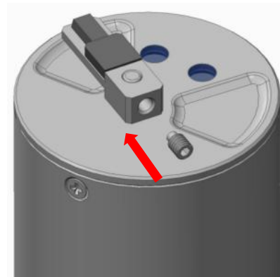
图 30. 安装新的M2螺钉
