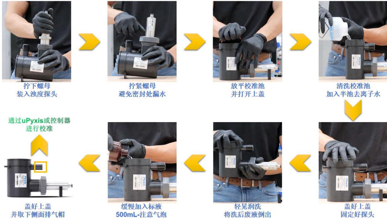
图12. L-CAL标液池操作步骤
