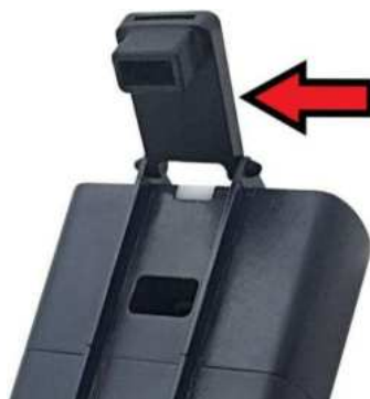
图 4. pH/ORP测量池密封帽处于开启位置
