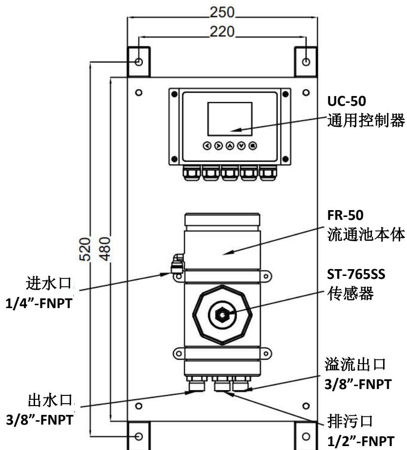
图4. IK-765SS-FCL余氯套装示意图 (mm)
