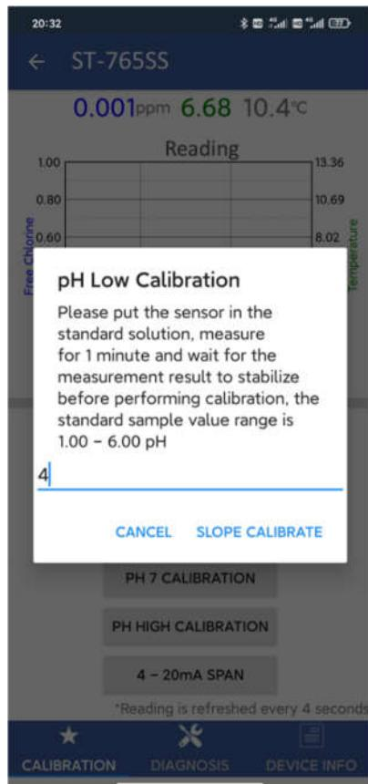
图13 输入pH浓度以启动pH低校准
