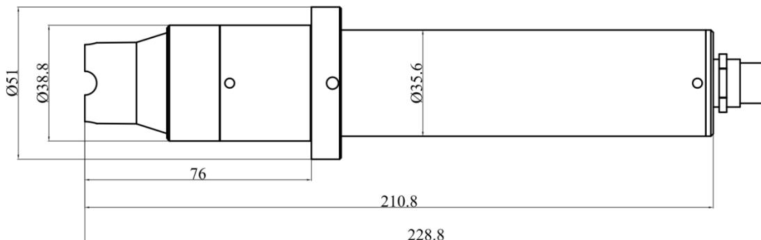
图1. ST-765SS余氯传感器的尺寸 (mm)
