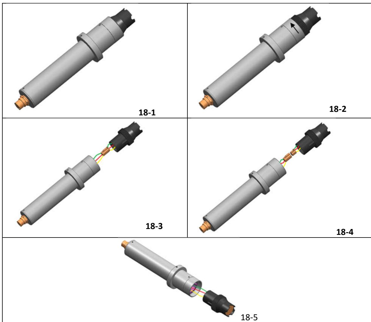
图18 更换余氯电极头
