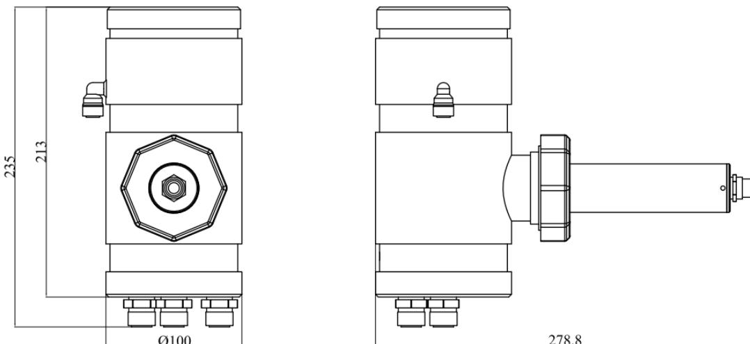
图3. FR-100流通池尺寸图 (mm)
