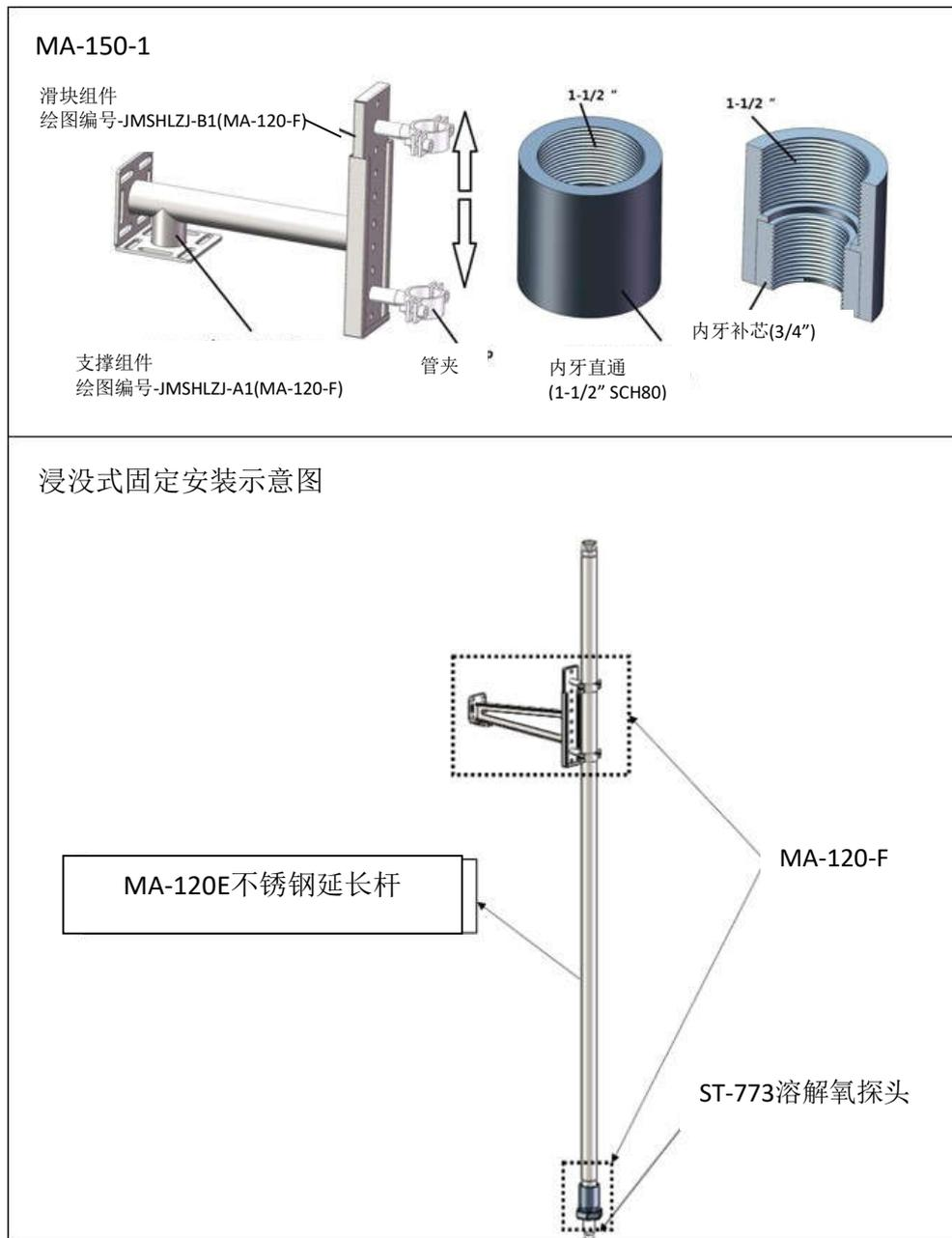
图 2. ST-773 浸没式固定安装
