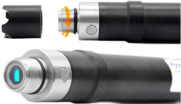
测量进行温度补偿。传感器前端可更换荧光帽完全由Pyxis自主研发，典型使用寿命可达两年。这种独特的荧光帽设计采用黑色微孔PTFE材料，使用寿命长、易于更换。传感器前端设计为平面结构，不易污染，且易于清理。传感器外壳采用PVC材质因而非常适合在恶劣或腐蚀环境中使用。提供浸没式固定安装和浸没式浮动安装方式。
